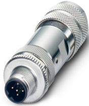
Datensteckverbinder, PROFIBUS, INTERBUS, 5-polig, geschirmt, Stecker gerade M12, Kodierung: B, Schraubanschluss, Rändelmaterial: Zinkdruckguss, vernickelt, Kabelverschraubung Pg11, Leitungsaußendurchmesser 8 mm ... 10 mm
