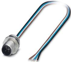
Gerätesteckverbinder Vorderwand, Universal, 4-polig, Stift, gerade, M12, A-Kodierung, auf freies Leitungsende, Einzellitzen, Kabellänge: 0,5 m, 0,34 mm<sup>2</sup>, TPE-Litze, vergossen
