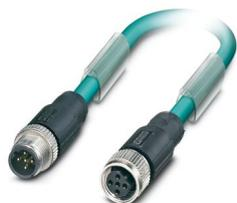
Bussystem-Kabel, PROFIBUS, 2-polig, PUR/PVC, blau, geschirmt, Stecker gerade M12, Kodierung: B, auf Buchse gerade M12, Kodierung: B, Kabellänge: 5 m
