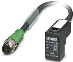
Sensor-/Aktor-Kabel, 3-polig, PUR halogenfrei, schwarzgrau RAL 7021, Stecker gerade M12, Kodierung: A, mit 1 LED, auf Ventilstecker C (8 mm), mit 1 LED, Beschaltung: Z-Diode, Kabellänge: 0,6 m
