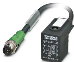
Sensor-/Aktor-Kabel, 3-polig, PUR halogenfrei, schwarzgrau RAL 7021, Stecker gerade M12, Kodierung: A, auf Ventilstecker BI (11 mm), Beschaltung: Z-Diode, Kabellänge: 3 m
