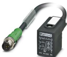
Sensor-/Aktor-Kabel, 3-polig, PUR halogenfrei, schwarzgrau RAL 7021, Stecker gerade M12, Kodierung: A, mit 1 LED, auf Ventilstecker BI (11 mm), mit 1 LED, Beschaltung: Z-Diode, Kabellänge: 1,5 m
