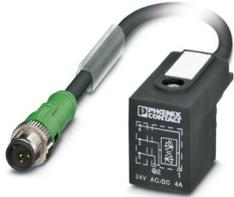
Sensor-/Aktor-Kabel, 3-polig, PUR halogenfrei, schwarzgrau RAL 7021, Stecker gerade M12, Kodierung: A, mit 1 LED, auf Ventilstecker BI (11 mm), mit 1 LED, Beschaltung: Z-Diode, Kabellänge: 0,6 m
