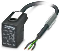
Sensor-/Aktor-Kabel, 3-polig, PVC, schwarz RAL 9005, freies Leitungsende, auf Ventilstecker B (10 mm), mit 1 LED, Beschaltung: Z-Diode, Kabellänge: 10 m
