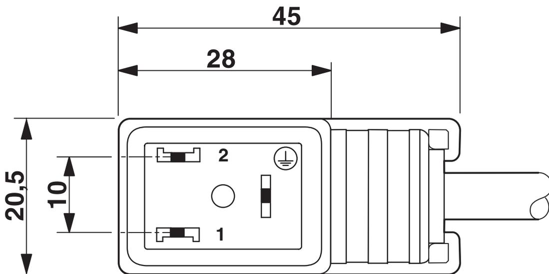
Ventilstecker, Bauform B
