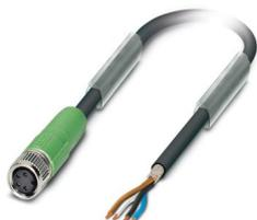
Sensor-/Aktor-Kabel, 4-polig, PUR halogenfrei, schwarzgrau RAL 7021, geschirmt, freies Leitungsende, auf Buchse gerade M8, Kodierung: A, Kabellänge: 15 m
