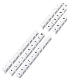
BNB-Zackband, 10-teilig, trennbar, längs bedruckt mit den fortlaufenden Zahlen: 71 ... 80, weiß, für Klemmenbreite: 7,5 mm, Montageart: stecken
