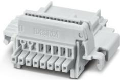
Tragschienen-Busverbinder, Farbe: lichtgrau, Nennstrom: 6 A (parallele Kontakte), Bemessungsspannung (III/2): 32 V, Polzahl: 8, Artikelfamilie: TBUS8-25..., Rastermaß: 2,54 mm, Montage: Tragschienenmontage, Verriegelung: ohne, Befestigungsart: ohne, Verpackungsart: verpackt im Karton, Artikel mit vergoldeten Kontakten, Busstecker zur Verbindung mit Elektronikgehäusen, 6 Parallelkontakte
