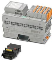
Axioline P, Temperaturerfassungsmodul, Analoge Eingänge: 8 (für resistive Temperatursensoren), Anschlussstechnik: 2-, 3-, 4-Leiter (geschirmt), Übertragungsgeschwindigkeit im Lokalbus: 100 MBit/s, RTD-Funktionalität, Schutzart: IP20, inklusive Bussockelmodul und Axioline P-Steckern
