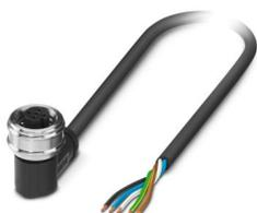
Sensor-/Aktor-Kabel, 5-polig, PUR halogenfrei, schwarzgrau RAL 7021, freies Leitungsende, auf Buchse gewinkelt M12 Push-Pull, Kodierung: A, Kabellänge: 10 m
