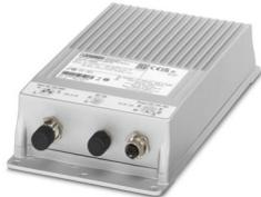
Primär getaktete Stromversorgung TRIO POWER in Druckgussgehäuse IP67, M12-Rundsteckverbinder, Eingang: 1-phasig, 5-poliger Ausgang: 24 V DC / 10 A , Statischer Boost: bis 12,5 A (dauerhaft)
