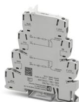
Das Invertermodul mit Schraubanschluss invertiert die Signale masseschaltender NPN-Transistor-Ausgänge in plusschaltende PNP-Ausgänge sowie auch Signale von PNP- in NPN-schaltende Signale.
