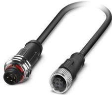
Sensor-/Aktor-Kabel, 4-polig, PUR halogenfrei, schwarzgrau RAL 7021, Stecker gerade M12 Push-Pull, auf Buchse gerade M12, Kodierung: A, Kabellänge: 3 m
