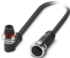
Sensor-/Aktor-Kabel, 4-polig, PUR halogenfrei, schwarzgrau RAL 7021, Stecker gewinkelt M12 Push-Pull, Kodierung: A, auf Buchse gerade M12 Push-Pull, Kodierung: A, Kabellänge: 0,6 m
