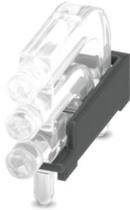
Mehrfachlichtleiter mit Überstrahlungsschutz, passiv, starr, Linsenkopf, Abstrahlfläche: sphärisch, Anzahl der Anzeigen: 3, (3 Reihen, 1 Spalte), Rastermaß: 2,54 mm, ESD-Schutz: <8 kV, nutzbar für die Gehäusefamilien ME, ME MAX, ME-IO, ME PLC und EH (Bearbeitung des Gehäuses erforderlich)
