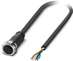
Sensor-/Aktor-Kabel, 4-polig, PUR halogenfrei, schwarzgrau RAL 7021, freies Leitungsende, auf Buchse gerade M12 Push-Pull, Kodierung: A, Kabellänge: 1,5 m
