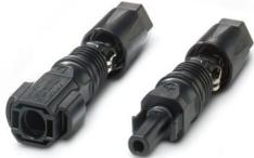
Photovoltaik-Steckverbinder, Artikelfamilie: SUNCLIX, Farbe: schwarz, Polzahl: 1, Aderquerschnitt min.: 2,5 mm<sup>2</sup>, Aderquerschnitt max.: 6 mm<sup>2</sup>, Bemessungsspannung: 1100 V DC, Bemessungsstrom: 20 A, Anschlussart: Federkraft, Kabeldurchmesser min.: 5,5 mm, Kabeldurchmesser max.: 8 mm, Set bestehend aus den Artikeln: 1x 1386381 und 1x 1386384
