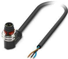
Sensor-/Aktor-Kabel, 3-polig, PUR halogenfrei, schwarzgrau RAL 7021, Stecker gewinkelt M12 Push-Pull, Kodierung: A, auf freies Leitungsende, Kabellänge: 1,5 m
