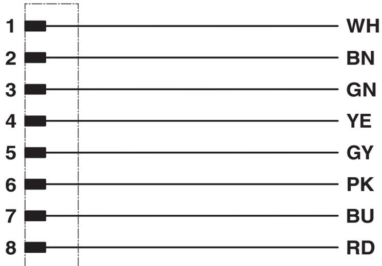
Kontaktbelegung des M8-Steckers
