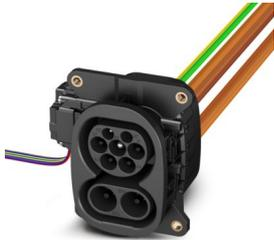
CHARX connect universal, DC CCS Typ 2, Fahrzeug-Ladedose, bis zu 500 A im Boost Mode, 200 A dauerhaft, 1000 V DC, Einzeladern, Länge: 4 m, Verriegelungsaktuator: 12 V, 4-polig, Vorder- und Rückwandmontage, M6, Gehäuse: schwarz, zum Laden mit Gleichstrom (DC), IEC 62196-2, IEC 62196-3, Für die DC-Kontakte ist eine Schutzkappe im Lieferumfang enthalten.
