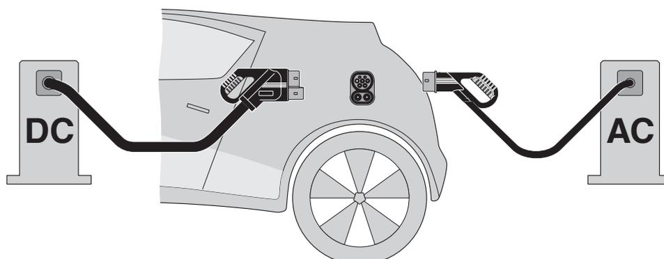
Prinzip des Combined Charging Systems (CCS) - normkonformes Ladestecksystem für Elektrofahrzeuge, das sowohl konventionelles Laden mit Wechselstrom (AC) als auch schnelles Gleichstromladen (DC) unterstützt. Beide Fahrzeug-Ladestecker passen in die CCS-Fahrzeug-Ladedose.
