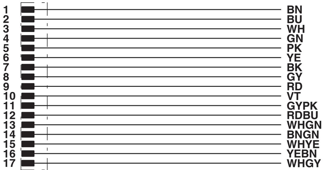
Kontaktbelegung des M12-Steckers
