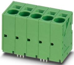
Leiterplattenklemme, Nennstrom: 76 A, Bemessungsspannung (III/2): 1000 V, Nennquerschnitt: 16 mm<sup>2</sup>, Anzahl der Reihen: 1, Polzahl pro Reihe: 10, Artikelfamilie: SPT 16/..-V, Rastermaß: 10 mm, Anschlussart: Push-in-Federanschluss, Montage: Wellenlöten, Anschlussrichtung Leiter/Platine: 90 °, Farbe: grün, Pin-Layout: Zick-Zack-Pinning M, Pinlänge [P]: 4,1 mm, Anzahl der Lötpins pro Potenzial: 3, Verpackungsart: verpackt im Karton
