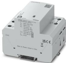
Kompakter, nicht-steckbarer und leckstromfreier Blitzstrom- / Überspannungsableiter auf Basis verschleißfreier Carbon-Funkenstreckentechnologie für 3-phasige Stromversorgungsnetze mit separatem N und PE (5-Leitersystem: L1, L2, L3, N, PE), geeignet für den Einsatz im Vorzählerbereich, Ableitvermögen bis 50 kA für die Blitzschutzklassen III und IV.
