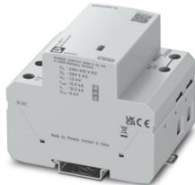
Kompakter, nicht-steckbarer und leckstromfreier Blitzstrom- / Überspannungsableiter auf Basis verschleißfreier Carbon-Funkenstreckentechnologie für 3-phasige Stromversorgungsnetze mit gemeinsamen N und PE (4-Leitersystem: L1, L2, L3, PEN), geeignet für den Einsatz im Vorzählerbereich, Ableitvermögen bis 50 kA für die Blitzschutzklassen III und IV.
