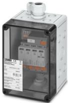
CHARX protect retrofit, Überspannungsschutz-Set zum Schutz von Ladestationen mit einer Leistung von 11 kW ... 22 kW, z. B. Wallboxen. Überspannungsableiter, bestehend aus Basiselement mit Push-in-Anschlussstechnik, Fernmeldekontakt und Schutzsteckern, Nennspannung: 230 V AC, 3+1-Schaltung
