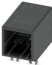
Leiterplatten-Grundleiste, Farbe: schwarz, Nennstrom: 5 A, Bemessungsspannung (III/2): 160 V, Kontaktoberfläche: Sn, Kontaktart: Stift, Anzahl der Reihen: 2, Polzahl: 8, Artikelfamilie: DD21H 0,85/..-H, Rastermaß: 2,5 mm, Montage: Wellenlöten, Pin-Layout: Lineares Pinning, Pinlänge [P]: 3,4 mm, Anzahl der Lötpins pro Potenzial: 1, Stecksystem: CONNEXIS DD, Ausrichtung Steckgesicht: Standard, Verriegelung: Rastverriegelung, Befestigungsart: Rastnase, Verpackungsart: verpackt im Karton
