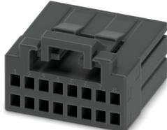
Leiterplattenstecker, Farbe: schwarz, Nennstrom: 5 A, Bemessungsspannung (III/2): 160 V, Kontaktobерfläche: Sn, Kontaktart: Buchse, Anzahl der Reihen: 2, Polzahl: 16, Artikelfamilie: DD21PC 0,85/..., Rastermaß: 2,5 mm, Anschlussart: Crimpanschluss, Anschlussrichtung Leiter/Platine: 0 °, Rasthaken: - ohne Rasthaken, Stecksystem: CONNEXIS DD, Verriegelung: Rastverriegelung, Befestigungsart: Rastflansch, Verpackungsart: verpackt im Karton
