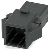
Durchführungsstecker, Farbe: schwarz, Nennstrom: 5 A, Bemessungsspannung (III/2): 160 V, Kontaktoberfläche: Sn, Kontaktart: Stift, Anzahl der Reihen: 2, Polzahl: 8, Artikelfamilie: DD21H 0,85/..-PT, Rastermaß: 2,5 mm, Anschlussart: Crimpanschluss, Anschlussrichtung Leiter/Platine: 0 °, Rasthaken: - ohne Rasthaken, Stecksystem: CONNEXIS DD, Ausrichtung Steckgesicht: Standard, Verriegelung: Rastverriegelung, Befestigungsart: Rastnase, Verpackungsart: verpackt im Karton
