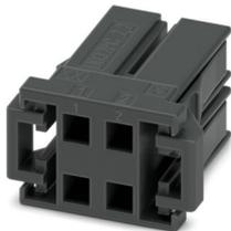
Leiterplattenstecker, Farbe: schwarz, Nennstrom: 8 A, Bemessungsspannung (III/2): 320 V, Kontaktoberfläche: Sn, Kontaktart: Buchse, Anzahl der Reihen: 2, Polzahl: 4, Artikelfamilie: DD32PC 2,2/.., Rastermaß: 5,08 mm, Anschlussart: Crimpanschluss, Anschlussrichtung Leiter/Platine: 0 °, Rasthaken: - ohne Rasthaken, Stecksystem: CONNEXIS DD, Verriegelung: Rastverriegelung, Befestigungsart: Rastflansch, Verpackungsart: verpackt im Karton
