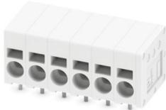
Leiterplattenklemme, Nennstrom: 24 A, Bemessungsspannung (III/2): 400 V, Nennquerschnitt: 2,5 mm<sup>2</sup>, Anzahl der Reihen: 1, Polzahl pro Reihe: 6, Artikelfamilie: SPT 2,5/...-H, Rastermaß: 5 mm, Anschlussart: Push-in-Federanschluss, Montage: Wellenlöten, Anschlussrichtung Leiter/Platine: 0 °, Farbe: weiß, Pin-Layout: Lineares Pinning, Pinlänge [P]: 2,5 mm, Anzahl der Löt pins pro Potenzial: 2, Verpackungsart: verpackt im Karton
