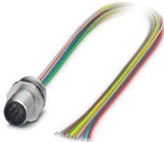
Gerätesteckverbinder Vorderwand, 8-polig, Stift, gerade, M12, A-Kodierung, auf freies Leitungsende, Einzellitzen, Kabellänge: 2,5 m, 0,25 mm<sup>2</sup>, TPE-Litze, vergossen, dieser Artikel ist voraussichtlich ab 2025-Q4 nach RoHS II ohne Ausnahme 6c (Pb < 0,1 %) bleifrei, auf Anfrage ist eine bleifreie Alternative vorab möglich
