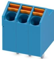
Leiterplattenklemme, Nennstrom: 9 A, Bemessungsspannung (III/2): 200 V, Nennquerschnitt: 1 mm<sup>2</sup>, Anzahl der Reihen: 1, Polzahl pro Reihe: 3, Artikelfamilie: SPTA 1/, Rastermaß: 3,5 mm, Anschlussart: Push-in-Federanschluss, Montage: Wellenlöten, Anschlussrichtung Leiter/Platine: 65 °, Farbe: blau, Pin-Layout: Lineares Pinning, Pinlänge [P]: 3,5 mm, Anzahl der Lötpins pro Potenzial: 1, Verpackungsart: verpackt im Karton
