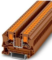
Durchgangsklemme, Nennspannung: 1000 V, Nennstrom: 41 A, Anzahl der Anschlüsse: 2, Polzahl: 1, Anschlussart: Push-in-Anschluss, Bemessungsquerschnitt: 6 mm<sup>2</sup>, Querschnitt: 0,5 mm<sup>2</sup> - 10 mm<sup>2</sup>, Montageart: NS 35/7,5, NS 35/15, Farbe: braun
