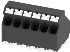
Leiterplattenklemme, Nennstrom: 32 A, Bemessungsspannung (III/2): 400 V, Nennquerschnitt: 4 mm<sup>2</sup>, Anzahl der Reihen: 1, Polzahl pro Reihe: 6, Artikelfamilie: SPTA 2,5/...-THR, Rastermaß: 5 mm, Anschlussart: Push-in-Federanschluss, Montage: THR-Löten / Wellenlöten, Anschlussrichtung Leiter/Platine: 45 °, Farbe: schwarz, Pin-Layout: Lineares Pinning, Pinlänge [P]: 2 mm, Anzahl der Lötpins pro Potenzial: 2, Verpackungsart: Gurt in 44 mm Breite
