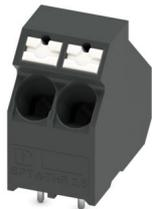
Leiterplattenklemme, Nennstrom: 32 A, Bemessungsspannung (III/2): 400 V, Nennquerschnitt: 4 mm<sup>2</sup>, Anzahl der Reihen: 1, Polzahl pro Reihe: 2, Artikelfamilie: SPTA 2,5/..-THR, Rastermaß: 5 mm, Anschlussart: Push-in-Federanschluss, Montage: THR-Löten / Wellenlöten, Anschlussrichtung Leiter/Platine: 45 °, Farbe: schwarz, Pin-Layout: Lineares Pinning, Pinlänge [P]: 2,6 mm, Anzahl der Lötpins pro Potenzial: 2, Verpackungsart: verpackt im Karton
