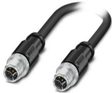
Hybridkabel, Ethernet Hybrid CAT5 (100 MBit/s), 8-polig, PUR halogenfrei, schwarz RAL 9005, geschirmt (Advanced Shielding Technology), Stecker gerade M12, Kodierung: Y / IP65/IP67, auf Stecker gerade M12, Kodierung: Y / IP65/IP67, Kabellänge: 3 m, Power with Ethernet (PWE)
