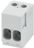
Leiterplattenklemme, Nennstrom: 41 A, Bemessungsspannung (III/2): 1000 V, Nennquerschnitt: 4 mm<sup>2</sup>, Anzahl der Reihen: 1, Polzahl pro Reihe: 2, Artikelfamilie: TDPT 4/..-SC, Rastermaß: 6,35 mm, Anschlussart: Schraubanschluss mit Zughülse, Schraubenangriffsform: L Längsschlitz, Montage: Wellenlöten, Anschlussrichtung Leiter/Platine: 0 °, Farbe: lichtgrau, Pin-Layout: Zick-Zack-Pinning W, Pinlänge [P]: 3,5 mm, Anzahl der Lötpins pro Potenzial: 1, Verpackungsart: verpackt im Karton
