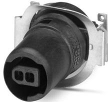
SPE-Leiterplatten-Steckverbinder, Bauform: SPE, Schutzart: IP65/IP67, Polzahl: 2, Material: LCP, Anschlussart: SMD, Kabelabgang: gerade, Farbe: schwarz, Single Pair Ethernet
