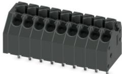
Leiterplattenklemme, Nennstrom: 8 A, Bemessungsspannung (III/2): 250 V, Nennquerschnitt: 1,5 mm<sup>2</sup>, Anzahl der Reihen: 1, Polzahl pro Reihe: 9, Artikelfamilie: PTSA 1,5, Rastermaß: 3,5 mm, Anschlussart: Push-in-Federanschluss, Montage: Wellenlöten, Anschlussrichtung Leiter/Platine: 45 °, Farbe: schwarz, Pin-Layout: Lineares Pinning, Pinlänge [P]: 3,5 mm, Anzahl der Lötpins pro Potenzial: 1, Verpackungsart: verpackt im Karton
