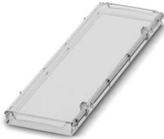
Tragschienegehäuse für den Einsatz in Installationsverteilern nach DIN 43880, transparenter Schwenkdeckel, plombierbar, ohne Einlegeblende, Breite: 161,6 mm, Höhe: 45 mm, Tiefe: 8 mm, Farbe: transparent
