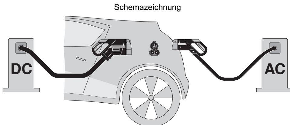
Prinzip des Combined Charging Systems (CCS) - normkonformes Ladestecksystem für Elektrofahrzeuge, das sowohl konventionelles Laden mit Wechselstrom (AC) als auch schnelles Gleichstromladen (DC) unterstützt. Beide Fahrzeug-Ladestecker passen in die CCS-Fahrzeug-Ladedose.
