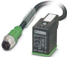
Sensor-/Aktor-Kabel, 3-polig, PUR halogenfrei, schwarzgrau RAL 7021, Stecker gerade M12, Kodierung: A, mit 1 LED, auf Ventilstecker B (10 mm), mit 1 LED, Beschaltung: Z-Diode, Kabellänge: 0,3 m, Kundenvariante, 180° Variante
