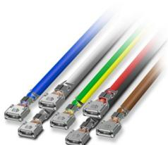
CHARX connect modular, Typ 2, Kabel-Set für Infrastruktur-Ladedose, 32 A , 480 V AC, Zubehör, Einzeladern, Länge: 2 m, Steckmontage, mit Flachsteckhülse einseitig, ausschließlich zum Anschluss an Infrastruktur-Ladesteckdosen der Generation 2 von Phoenix Contact, IEC 62196-2
