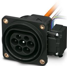
CHARX connect universal, AC Typ 2, Fahrzeug-Ladedose, 32 A , 480 V AC, Einzeladern, Länge: 12 m, Verriegelungsaktuator: 24 V, 4-polig, Vorder- und Rückwandmontage, M6, Gehäuse: schwarz, zum Laden mit Wechselstrom (AC) von Elektrofahrzeugen (EV), IEC 62196-2, Für die AC-Kontakte ist eine Schutzkappe im Lieferumfang enthalten.
