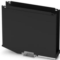
Tragschienengehäuse, Gehäuseunterteil mit Metallfußriegel, Breite: 25 mm, Höhe: 122,5 mm, Tiefe: 108,35 mm, Farbe: lichtgrau (ähnlich RAL 7035), Querverbindung: Tragschienen-Busverbinder (optional), Polzahl Querverbinder: 8
