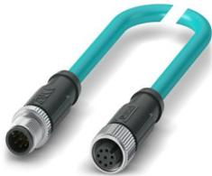
Netzwerkkabel, Ethernet CAT5, 8-polig, PUR halogenfrei, wasserblau RAL 5021, geschirmt, Stecker gerade M12, Kodierung: A / IP67, auf Buchse gerade M12, Kodierung: A / IP67, Kabellänge: 50 m
