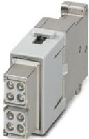
Kontakteinsatzmodul, Polzahl: 8, Buchse, Crimpanschluss, 48 V, 10 A, 0,14 mm<sup>2</sup> ... 1,5 mm<sup>2</sup>, Leitungsaußendurchmesser: 4,5 mm ... 9 mm, Anwendung: Daten/Signal, ohne Crimpkontakte, mit zwei Kabelabgängen
